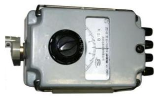
ZC—8 型接地电阻测试仪
