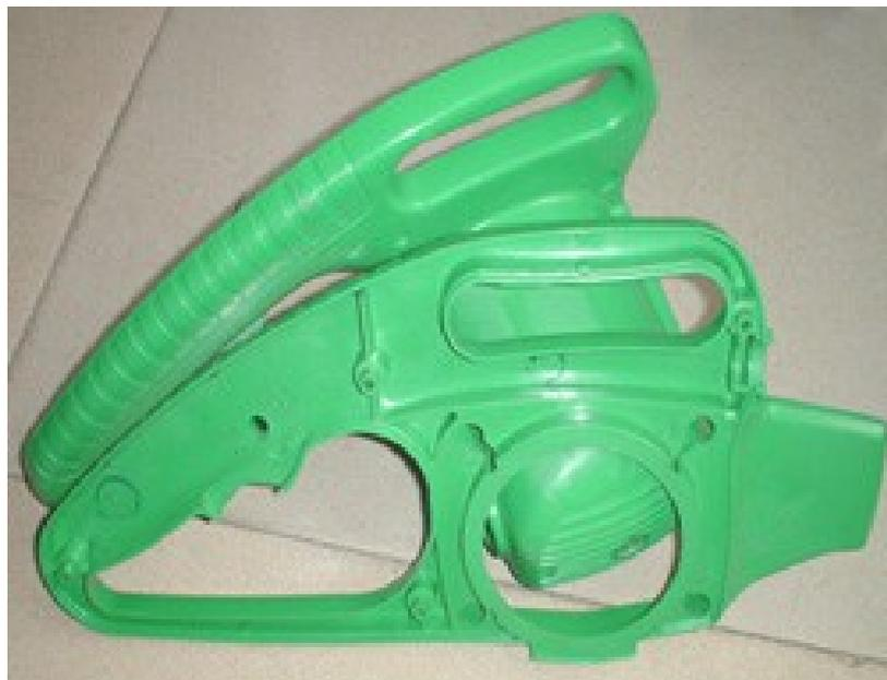
图 3-11 边缘和边角带有圆角的制件外形图
