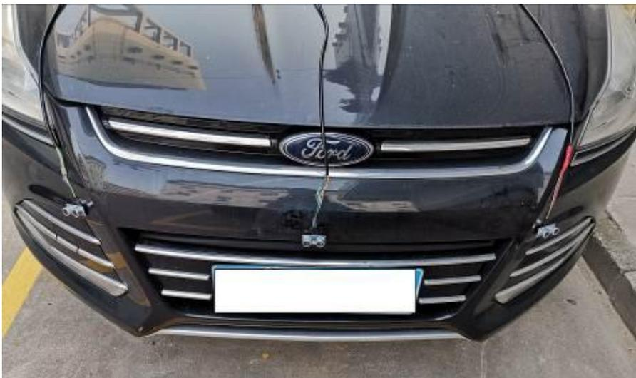
图 6 车前测点安装图
